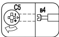
ориентация стяжки C5 - показана на рис, после сборки с дюбелем B4 стяжку затянуть по стрелке
